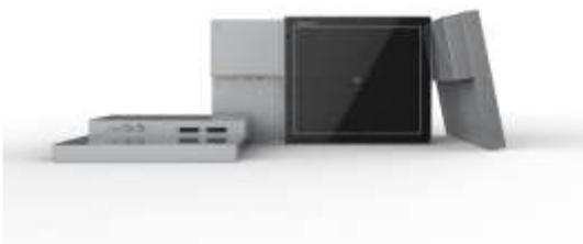
自動X線検査装置(AXI)用 CMOS 大型検出器 21x21cm、高解像度 90um で、様々なワークの検出が可能です。デュアルカメラリンクで、ハイスピード 30fps(ノンビニング)を実現、インライン 2 次電池検査に最適です。エネルギーレンジ 40～160kV。
