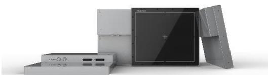
自動 X 線検査装置 (AXI) 用 CMOS 大型検出器 21x21cm、高解像度 90um で、様々なワークの検出が可能です。デュアルカメラリンクで、ハイスピード 30fps (ノンビニング) を実現、インライン 2 次電池検査に最適です。エネルギーレンジ 40～160kV。
