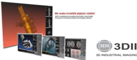
3DII 社の VX3D は、CT データの可視化と分析用のソフトウェアプラットフォームです。オートクロッピング、クリッピング、ズームキューブ機能等を使用することにより、直観的な自動可視化ソリューションを可能にします。HADI は 2D X 線画像の高性能検査処理ソフトウェアで、欠陥解析に有効なツールです。
